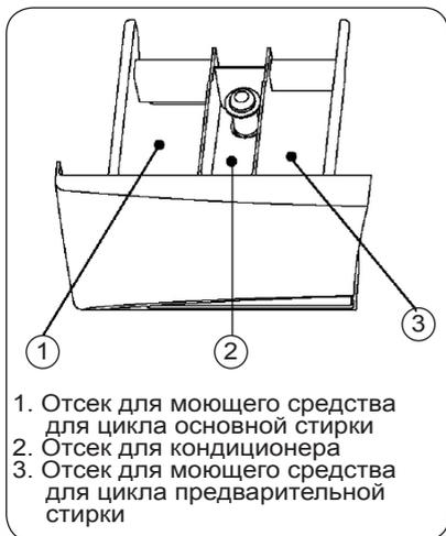
Помещайте моющее средство в отсек для цикла предварительной стирки только в том случае, если Вы устанавливаете функцию “Предварительная стирка”.
