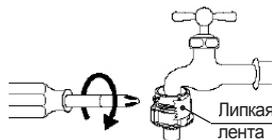
4. Создайте герметичность соединения, накрутив соединительную часть (В) на соединительную часть (А) по часовой стрелке.
