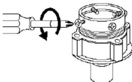
3. Соедините муфту с водопроводным краном, равномерно затянув четыре винта. Снимите липкую ленту.
