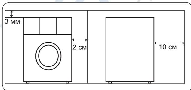
При установке стиральной машины в целях обеспечения нормальной вентиляции должны быть выдержаны минимальные зазоры, как показано на рисунке.
