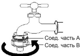
5. Осуществите соединение наливного шланга с переходной муфтой, потянув вниз подвижную часть зажимного устройства на шланге.
