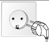
Для обеспечения электробезопасности стиральная машина должна быть подключена к сети электропитания с помощью индивидуальной розетки с заземляющим контактом.
